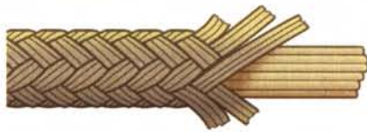
Figure 3 Cordage tressé dont l'âme est constituée de brins parallèles; exemple photographique ci-dessous.
