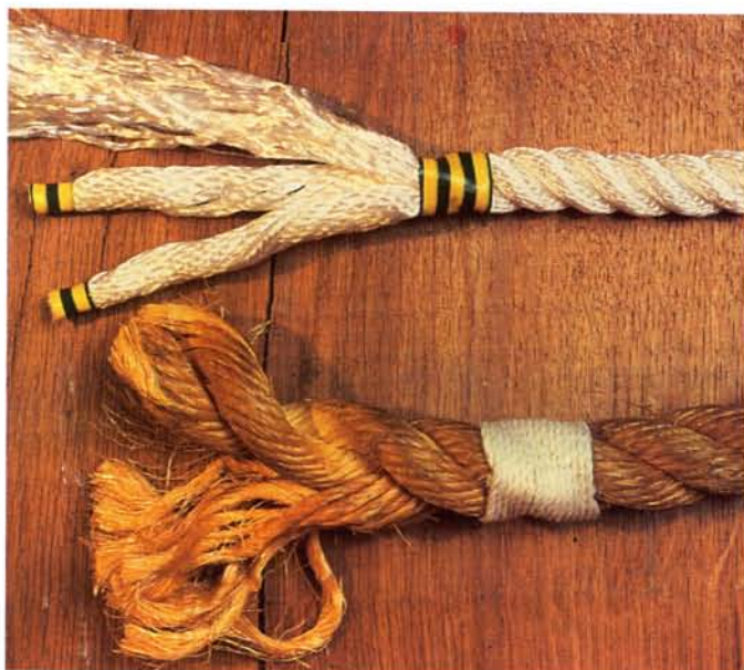
Figure 2 Un cordage tissé à huit torons formé à partir de quatre paires de gros torons peut servir d'amarre pour les gros navires. La photographie ci-dessous montre toutefois une version beaucoup plus petite de ce cordage, plutôt réservé à un usage domestique.
